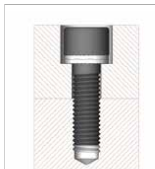
Zylinderschraube in Senkung gesichert
