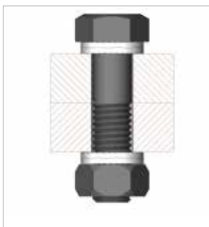
Sechskantschraube im Durchgangsloch beidseitig gesichert
