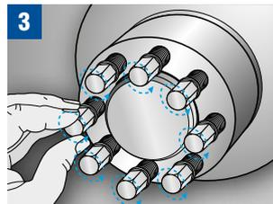
Nach drei Löserunden sollten die Druckbolzen soweit entlastet sein, dass nun einer nach dem anderen vollständig gelöst werden kann. Andernfalls Schritt 2 so oft wie nötig wiederholen.
