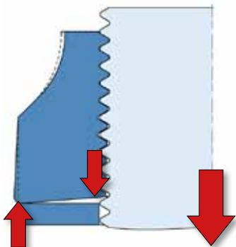
Die Auflagefläche der HEICO-TEC® Reaktionsmutter ist konkav und kann so in Richtung der Schraubenachse elastisch federn. Dadurch erhöht sich die Nachgiebigkeit der Schraubenverbindung. So verhält sich eine kurze Schraubenverbindung, die anfällig für Dauerbrüche und selbsttätiges Lösen ist, wie eine um 2-3 Gewindelängen längere Schraubenverbindung, die haltbarer und sicherer ist. Dies funktioniert nur durch Austauschen der Sechskantmutter durch eine HEICO-TEC® Reaktionsmutter!
