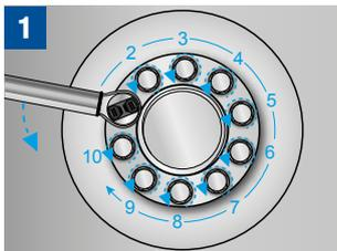
Beginnend mit einem beliebigen Druckbolzen im Kreis jeden Druckbolzen losbrechen, d.h. dass er sich etwas drehen lässt.
