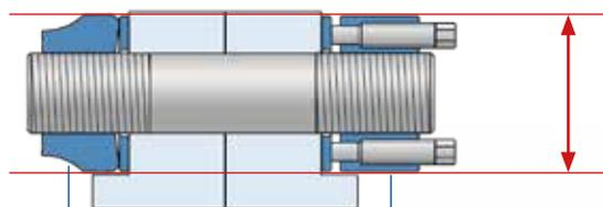
Spannmutter und Reaktionsmutter haben die gleichen Abmessungen
