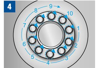
Im Kreis alle Druckbolzen mit dem empfohlenen Anziehdrehmoment anziehen. Den Schritt wiederholen, bis alle Druckbolzen gleichmäßig angezogen sind.
