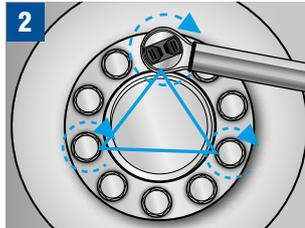
Drei beliebige Druckbolzen, die etwa gleich weit voneinander entfernt sind, der Reihe nach handfest anziehen, sodass die Druckbolzen die Druckscheibe berühren. Anschließend unter Last die drei Druckbolzen im Wechsel max. jeweils 1/2 Umdrehung anziehen, bis das empfohlene Drehmoment erreicht wird.
