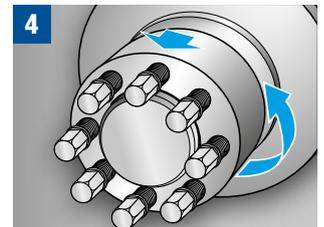
Spannmutter herunterschrauben und Scheibe entfernen.
