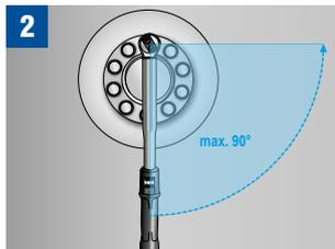
Im Kreis jeden Druckbolzen max. 1/4 Umdrehung lösen. Diesen Schritt zweimal wiederholen.
