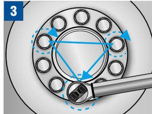
Drei weitere Druckbolzen, die ungefähr gleich weit voneinander entfernt sind, mit dem empfohlenen Anziehdrehmoment anziehen.
