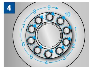
4 En un patrón circular, apriete cada uno de los pernos de compresión hasta el par de apriete recomendado. Repetir este paso hasta que todos los pernos de compresión queden apretados con el mismo torque.
