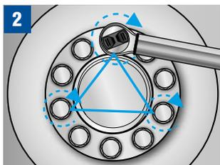
2 Apretar manualmente tres pernos de compresión aproximadamente equidistantes entre si, hasta que los tres toquen la arandela endurecida. Después, apriete los tres pernos de compresión alternativamente en rangos máximos de  $\frac{1}{2}$  vuelta cada uno, una y otra vez, hasta que los tres alcancen el par de apriete recomendado.
