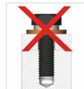
Nessuna funzione di fissaggio in combinazione con rondelle piane e mobili
