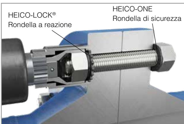
Utilizzo delle rondelle di reazione HEICO-LOCK® e della rondella di sicurezza HEICO-ONE in un foro passante.
