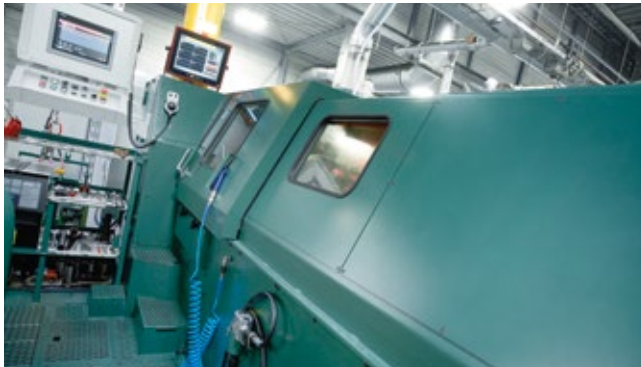
Prensas de hasta 6 operaciones inclusive precalentamiento del material
