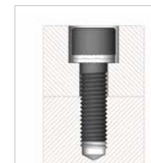
Bullone cilindrico su foro alesato
