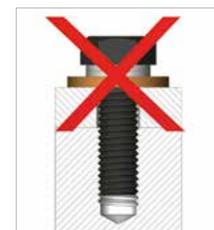
Geen borgingsfunctie in combinatie met onderleggingen
