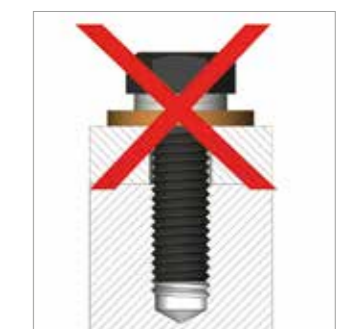
Ingen låsfunktion i kombination med osäkrad bricka.
