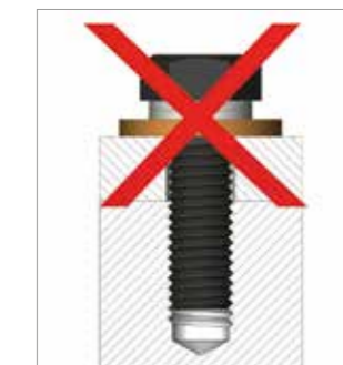
叠加可自由转动的平垫导致防松功能丧失
