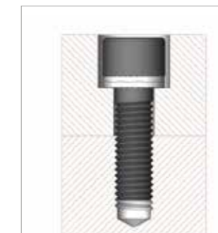
沉孔中的内六角螺栓被安全定位
